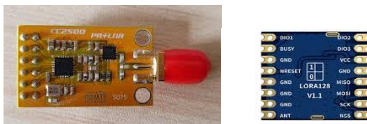
2.2-сурет – CC2500 және SX1280 модулі
